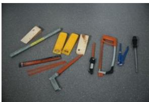
**RC 2 N/RC 2:** Der Gelegenheitstäter versucht, zusätzlich mit einfachen Werkzeugen wie Schraubendreher, Zange und Keile, das Bauteil aufzubrechen. Das Bauteil muss dem mindestens 3 Minuten standhalten.
