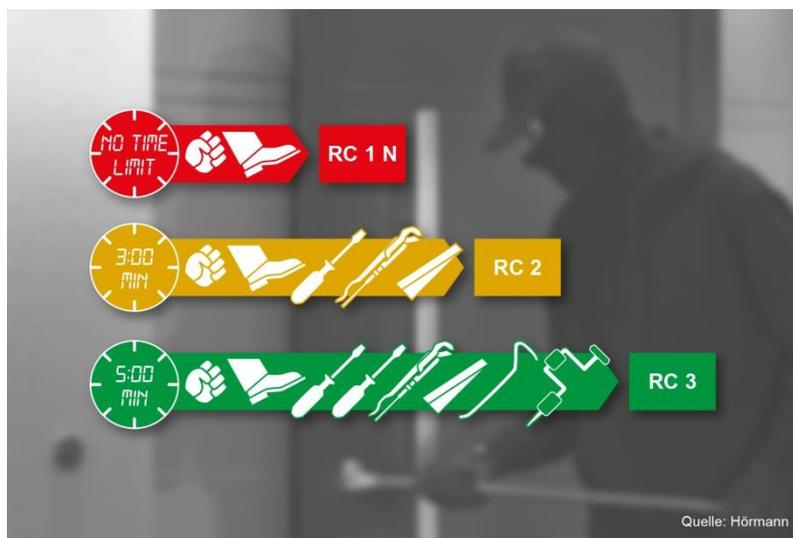
**Bild 7:** Die Widerstandsklassen RC 2 und RC 3 werden für Wohnungen und Häuser empfohlen. Die Klassen RC 4 bis RC 6 finden meist in gewerblich genutzten Gebäuden wie Banken Anwendung. Bei Haustüren mit Seitenteilen und/oder Oberlichtern sollte darauf geachtet werden, dass auch diese der Widerstandsklasse der Tür entsprechen.
