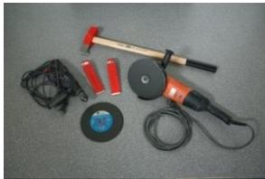
**RC 6:** Der erfahrene Täter setzt zusätzlich leistungsfähige Elektrowerkzeuge, wie z. B. Bohrmaschine, Stich- oder Säbelsäge und Winkelschleifer ein. Einem solchen Angriff muss das Bauteil mindestens 20 Minuten standhalten.
