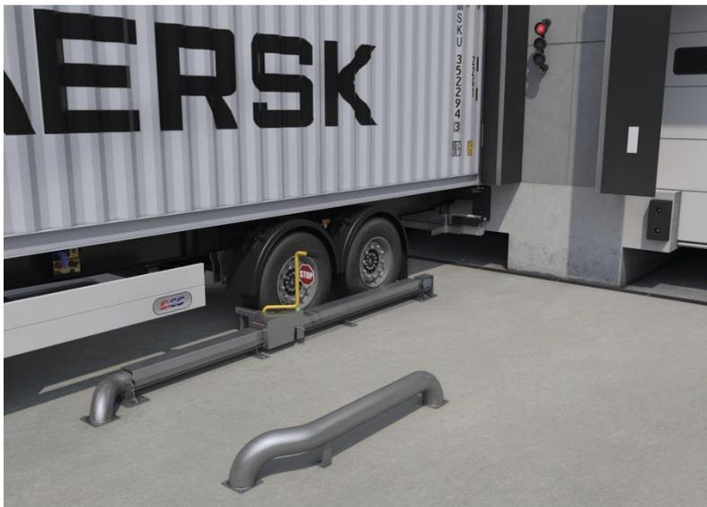
**Bild 2:** Auf der rund fünf Meter langen Radführung befindet sich der drehbare Verriegelungsarm mit ausklappbarem Stützfuß. Dieser wird durch eine 90 Grad-Drehung vor den Reifen geführt, sodass ein Wegrollen praktisch verhindert wird.
