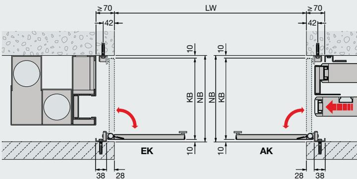
**Deckenklappen für den Sturzbereich**
