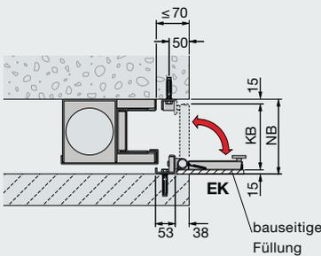
**Deckenklappen für den Sturzbereich**
