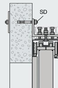
Nur in Verbindung mit einem Stahlbetonsturz gemäß statischem Nachweis. Der Sturz ist entsprechend der Laufschiene Länge über den Toröffnungsbereich hinaus zu führen.
