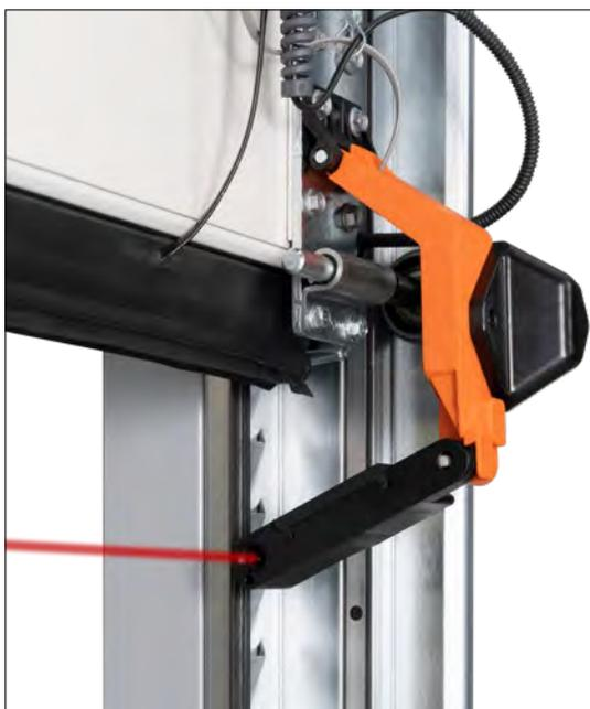
**BERÜHRUNGSLOSE SICHERHEIT.** Eine effiziente Überwachung der Schließkante erhöht die Sicherheit. Die Antriebe WA 500, WA 500 FU und ITO 500 FU statten wir optional ohne Aufpreis mit der voreilenden Lichtschranke VL1-LE aus. Diese reagiert berührungslos auf Bewegungen und Hindernisse und stoppt das Tor im Bedarfsfall sicher.
