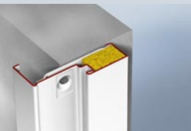
DryFix Zarge mit werkseitiger Mineralwollfüllung und verdeckter Diagonal-Befestigung im Zargenfalz.
