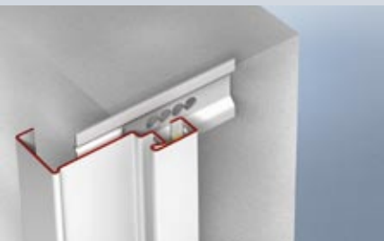
Profil 1 der Zarge in die Öffnung stellen und ausrichten.
